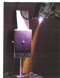
Рис. 5. Современные покрытия и способы нанесения. Плазменное напыление ТЗП на рабочую лопатку (справа)
