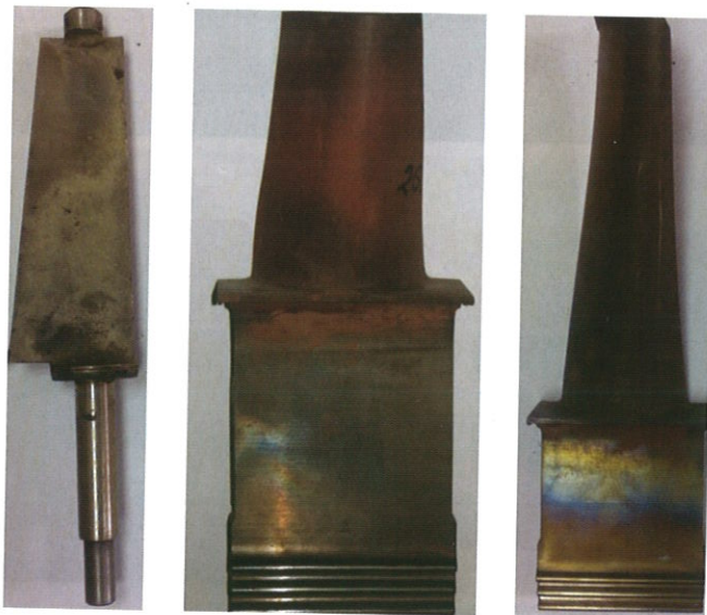
Фото 10. Лопатки ВНА, ТВД, ТНД турбины ГТК-25ИР до восстановления
