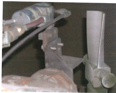
Фото 11. Процесс плазменного напыления покрытия на основе Co-Cr-Al-Si-Y на РЛ ТВД
